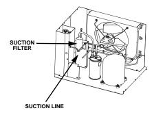
MINIMIZE THE TIME THE REFRIGERATION SYSTEM IS EXPOSED TO THE ATMOSPHERE (15 MINUTES MAXIMUM).
