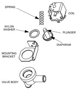
**Dump Valve Disassembly**
